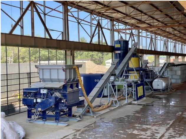
*Die KMF-Anlage im Recycling Center Himberg bereitet Mineralwolle effektiv auf © PORR*
